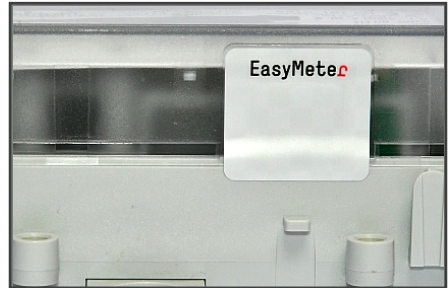
Abb. oben: Benutzersicherung für die MSB-DSS (per Siegelkitt)
