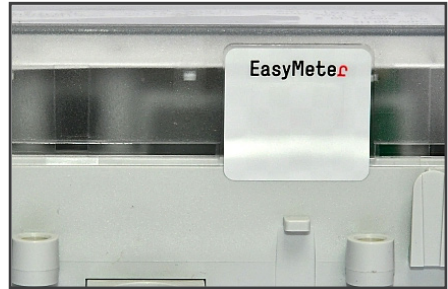
Abb. oben: Benutzersicherung für die MSB-DSS (per Siegeletikett)
